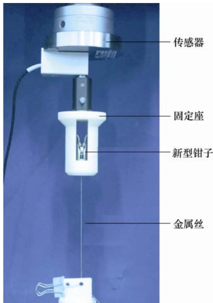
图 15 新型微创手术钳试验测力图
